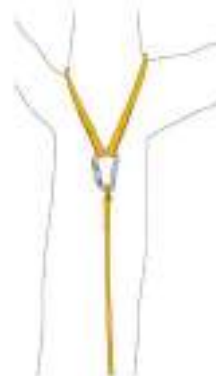
Fig. 5 - Ancoraggio della fune con dispositivo passante
