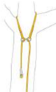
Fig. 8 - Ancoraggio passante per corda raddoppiata
