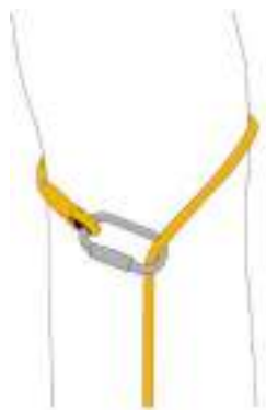
Fig. 2 - Strozzo diretto della fune
